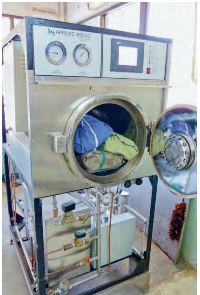
In diesem Gerät werden alle Instrumente am XKHPH sterilisiert. ເຄື່ອງມືທຸກຢ່າງຂອງໂຮງໝໍແຂວງຊຽງຂວາງຈະນຳເອົາມາຂ້າເຊື້ອດ້ວຍເຄື່ອງຈັກນີ້
